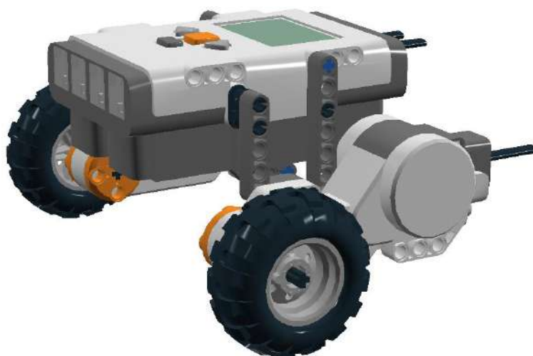
Рис. 3.73. Широкая тележка — простейший вариант.
