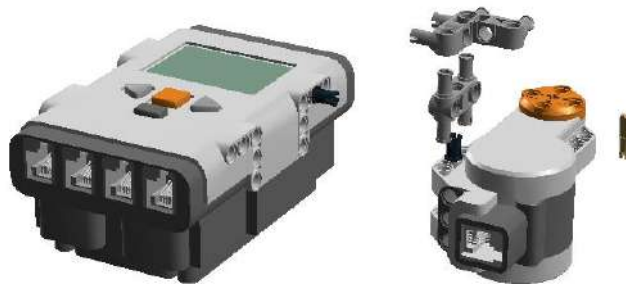
Рис. 8.148. Крепление мотора к корпусу NXT горизонтально на уровне поверхности. Штифт-полуось вставляется в вал мотора снизу.
