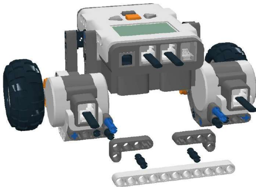
Рис. 3.83. Еще пара уголков, к которым крепится задняя балка.
