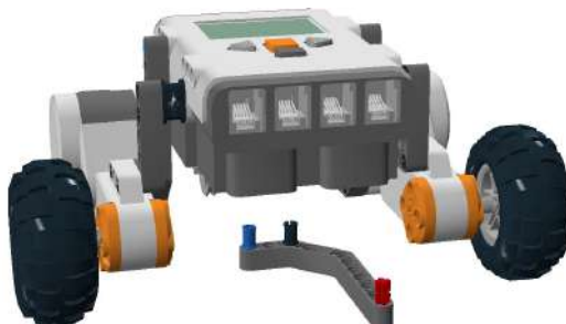
Рис. 8.33. Крепление датчика освещенности к трехколесной тележке.
