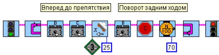
Рис. 8.81. Алгоритм путешествия по комнате с поворотом задним ходом.
