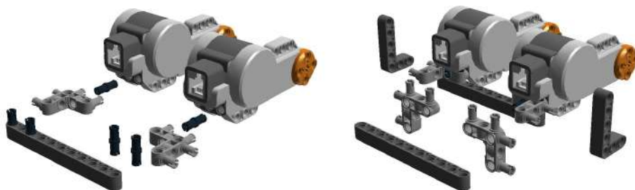
Рис. 8.111. Крепление моторов с помощью 11-модульной балки и угловых соединительных штифтов.
