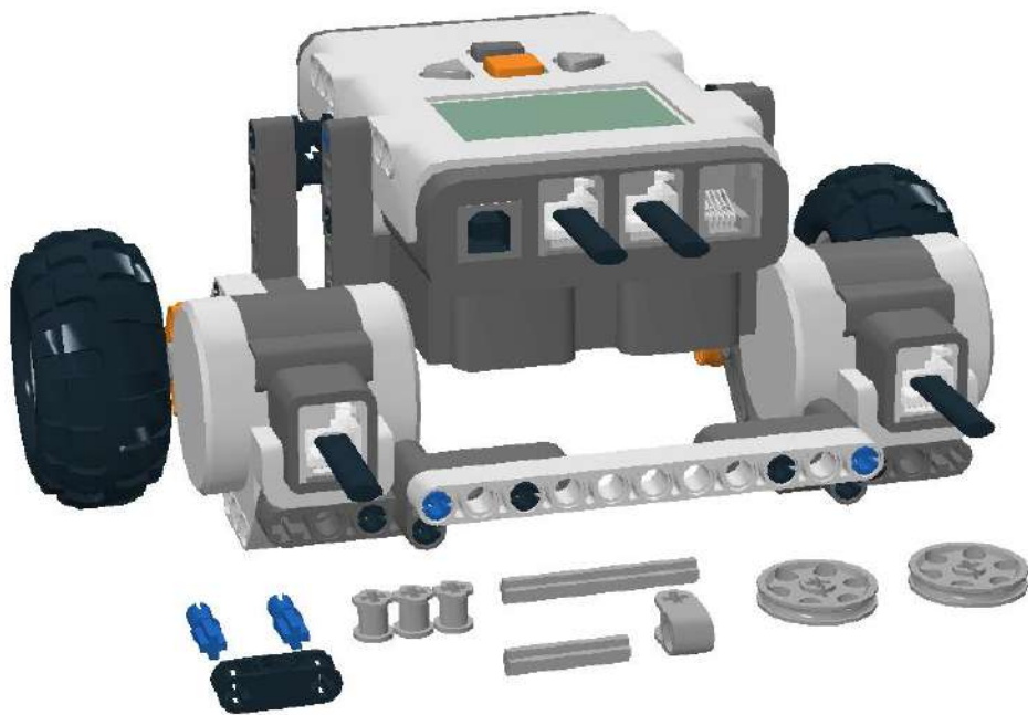
Рис. 3.84. Шины на диски подвижного колеса можно не надевать.
