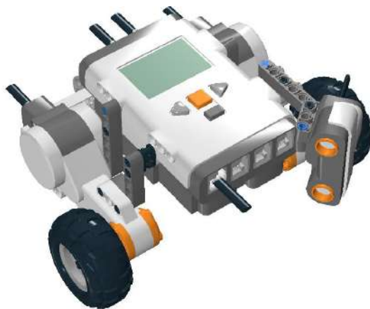
Рис. 8.91. Увеличенное за счет корпуса робота расстояние до стены способствует расширению области обзора.
