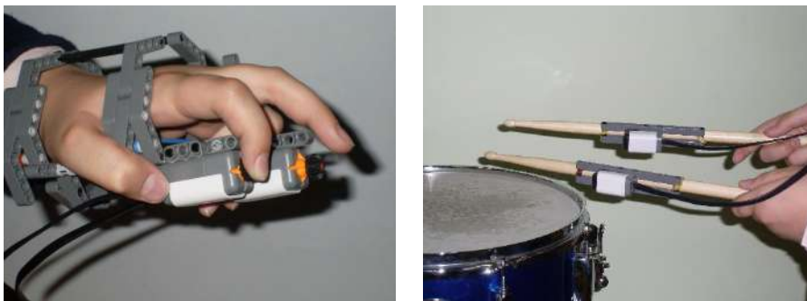
Рис. 8.103. Конструкции для управления роботом-барабанщиком: слева — на датчиках касания, справа — на гироскопических датчиках.
