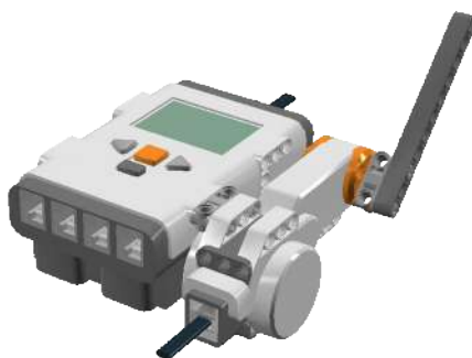
Рис. 7.1. Стабилизация мотора в положении 45 градусов.
