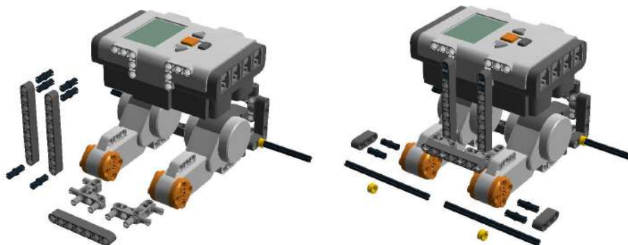
Рис. 8.114. Вертикальные балки для крепления NXT спереди могут быть любой длины. В оранжевые диски моторов вставляются 10-модульные оси.
