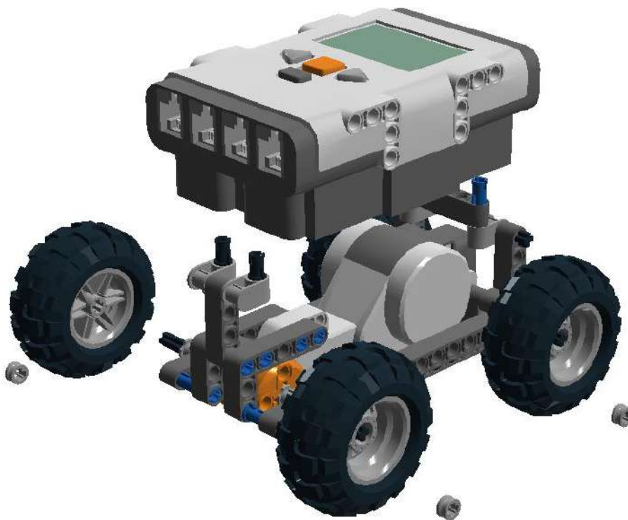
Рис. 3.19. Для надежности колеса закрепляются полувтулками.
