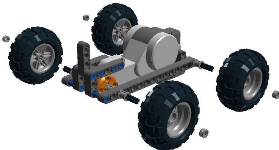
Рис. 3.10. Колеса крепятся так, чтобы не было трения с балками.
