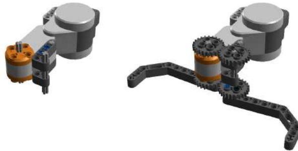
Рис. 8.151. Установка захвата на второй мотор.
