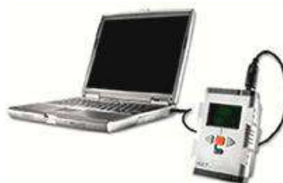
Рис. 5.2. Соединение NXT с компьютером через USB.
