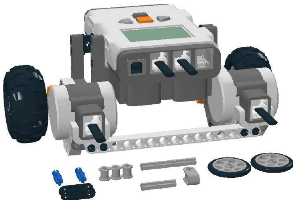
Рис. 3.79. Элементы подвижного колеса. Длины осей — 3 и 5 модулей.
