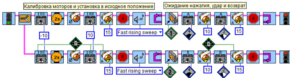
Рис. 8.102. Алгоритм управления палочками с помощью двух датчиков.
