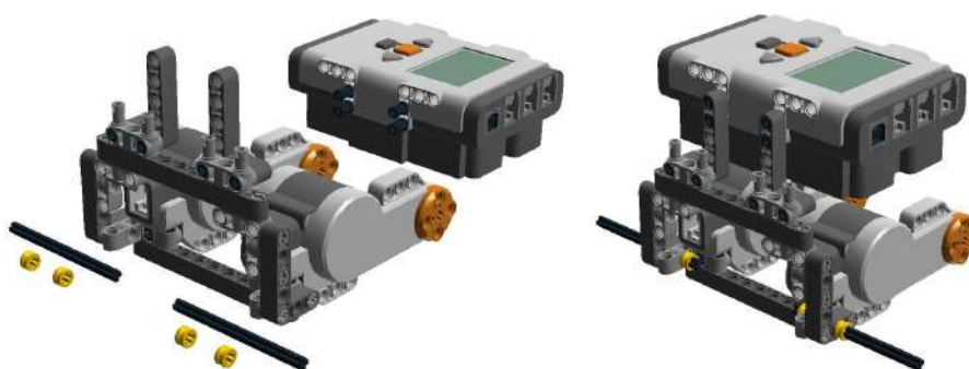
Рис. 8.113. Для крепления колесных дисков используются 8-модульные оси в задней части робота.
