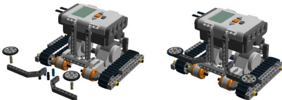
Рис. 8.120. Горизонтальные колесики устанавливаются на гладкие штифты или оси в круглые отверстия на изогнутых балках.
