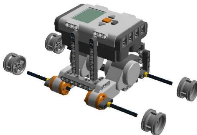
Рис. 8.115. Колесные диски прижимаются к желтым втулкам.
